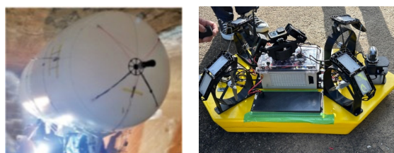
図2 飛行型（左）と船型（右）の水路点検ロボット
